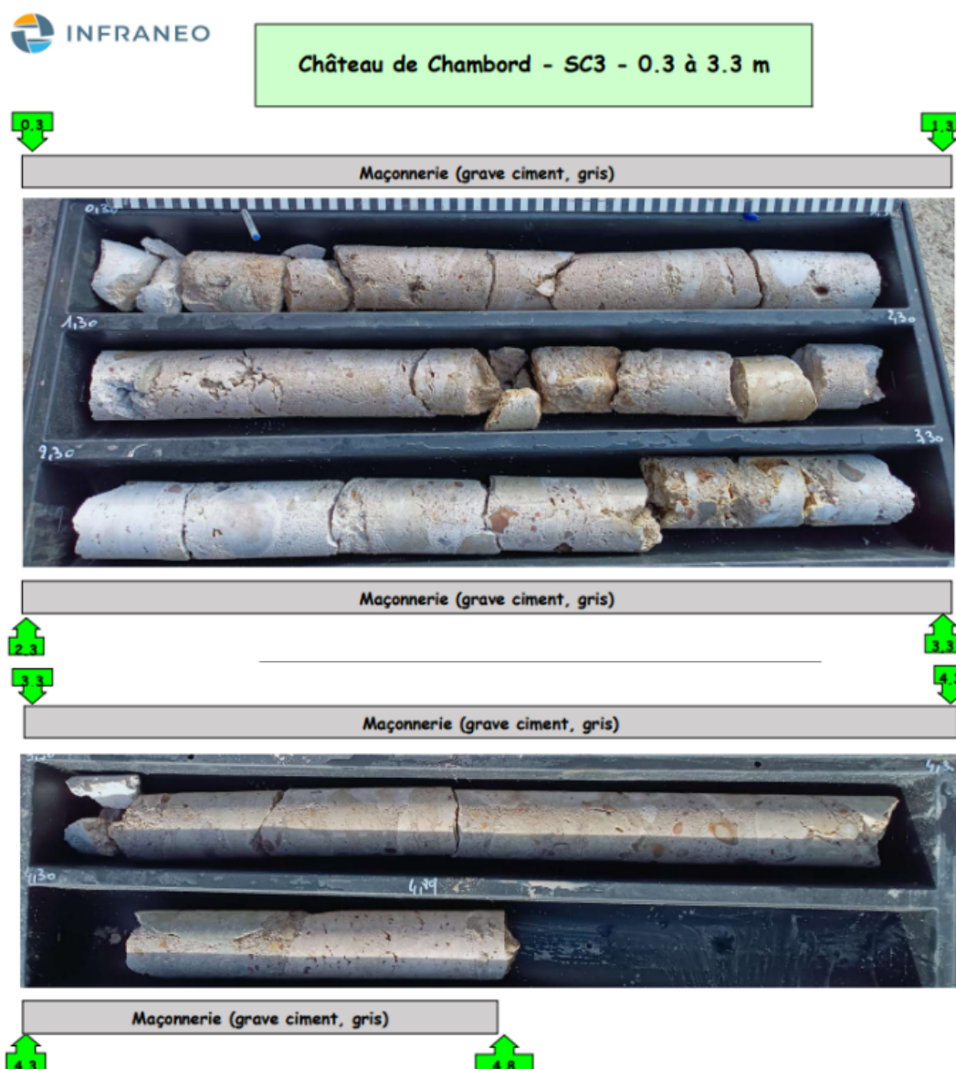
Figure 15 : Sondage carotté SC3 octobre 2022. Source : rapport INFRANEO n°PO22-0059
